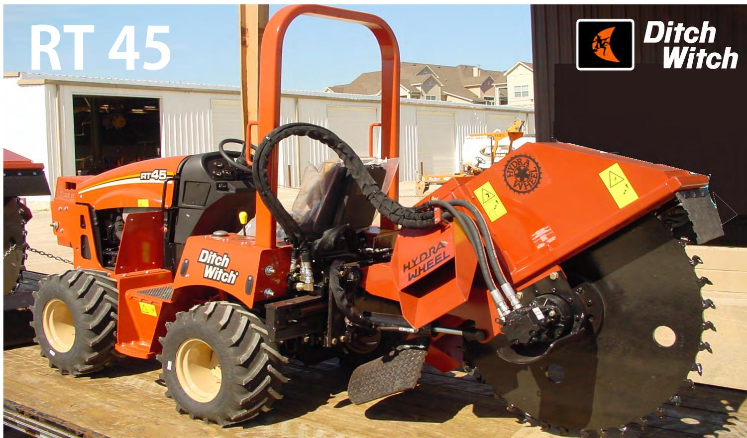
La Ditch Witch RT45 grazie al potente motore Tier 4, ha potenza in abbondanza per aggredire il terreno, grazie all'ampia gamma di attrezzi che comprendono scavatrice, braccio escavatore, disco tagliaroccia, interruttore vibrante, microscavatrice oppure il modulo combo catena/interruttore. L'operatore può beneficiare di una postazione comoda e spaziosa.
