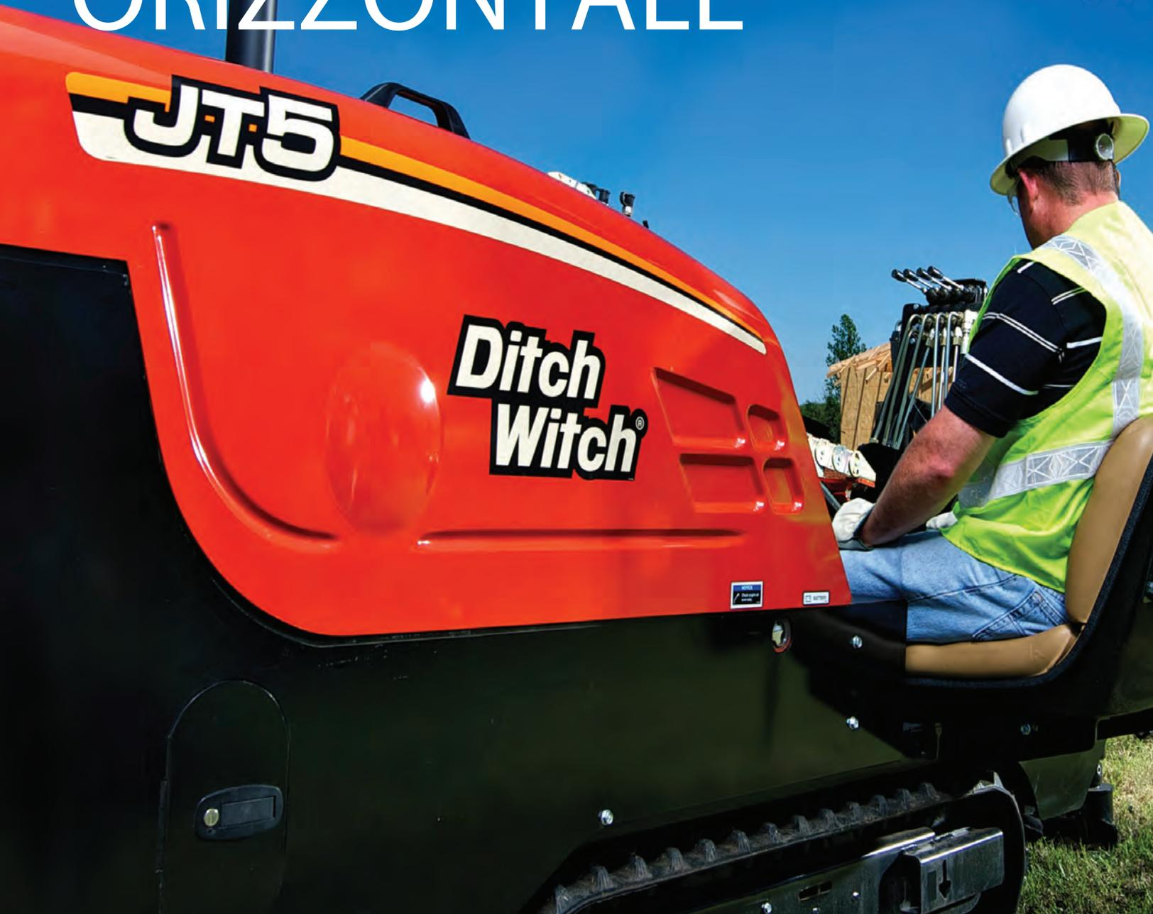
Solo l'esperienza ha permesso la nascita della Perforatrice Orizzontale Ditch Witch<sup>®</sup> JT5, la soluzione compatta con la giusta potenza di tiro e spinta ideale per l'installazione, in spazi ristretti, di cavi, fibra ottica e tubi fino a 46 metri sotto strade, viali, marciapiedi, parchi, e altri ostacoli di superficie.
