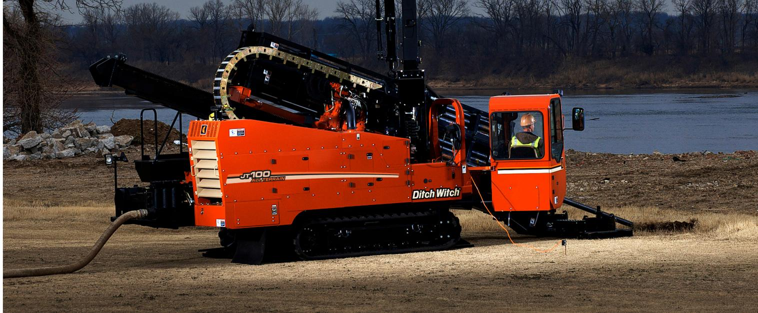
Per i lavori di posa più lunghi, attraverso molteplici tipologie di terreno, inclusa la roccia compatta, c'è bisogno della potenza e tecnologia superiori di Ditch Witch, c'è bisogno della JT100 All Terrain. Con i suoi 268HP la JT100 All Terrain è la perforatrice orizzontale Ditch Witch più potente progettata per massimizzare la produttività grazie alla tecnologia brevettata All Terrain ed al sistema di perforazione a doppia asta che consente di perforare e sterzare simultaneamente.
