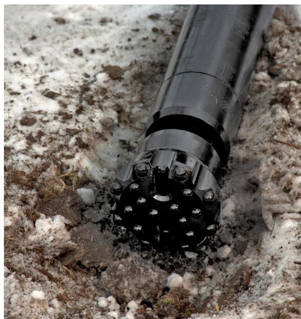
HammerHead è orgogliosa di presentare il nuovo martello ad aria ROUGHNECK R400 per la posa di tubi, cavidotti ed infrastrutture con le perforatrici teleguidate. Il Roughneck R400 è progettato per perforazioni in roccia con un avanzamento di 50 m/h e con una eccezionale capacità di sterzata
