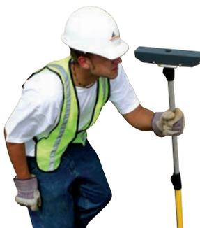
Il mirino di allineamento è regolabile in altezza e particolarmente utile nelle perforazioni più lunghe. Robusto ma leggero è dotato di testa removibile per il trasporto sicuro.
