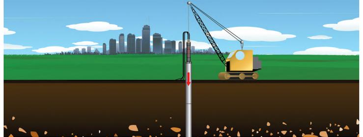
Con questo metodo si possono facilmente infiggere verticalmente tubi in acciaio, riducendo notevolmente i costi per creare fondazioni o pali verticali.
