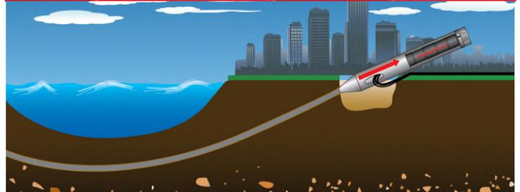
Metodo utilizzato per recuperare aste rimaste sotto terra a seguito di rotture di qualche giunto. Il martello pneumatico viene collegato alle aste con un adattatore e la forza di impatto del martello combinata al tiro della perforatrice estrae la batteria di aste.
