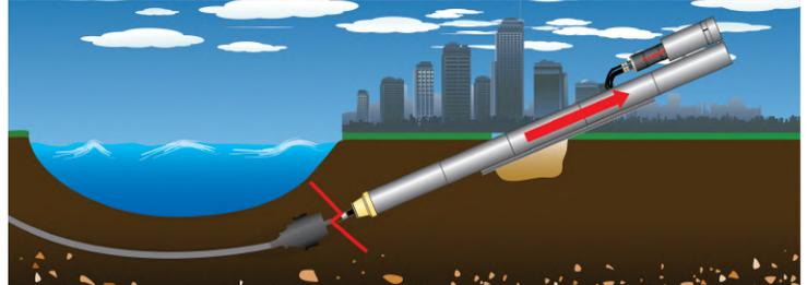
In condizioni di tubo bloccato sotto terra, il tubo può essere rimosso con martelli pneumatici cosicchè possa essere riutilizzato per un altro lavoro. Se una perforazione non dovesse andare a buon fine, il martello pneumatico può essere collegato al tubo. La forza di impatto del martello combinata al tiro meccanico della perforatrice è in molti casi sufficiente a estrarre il tubo bloccato.
