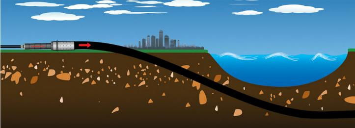
Questo metodo PipeRamming è usato per evitare condizioni di "idro-lock" durante una perforazione orizzontale. Se durante la fase di tiro il tubo dovesse bloccarsi, le percussioni del martello pneumatico aiutano a sbloccarlo. Questa azione può essere utilizzata anche durante il di tiro per mantenere il tubo in movimento, alleviare lo stress al prodotto da posare e aiutare la perforatrice a tirarlo sotto terra.
